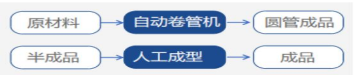
图 2-5 管件生产车间工艺流程图
